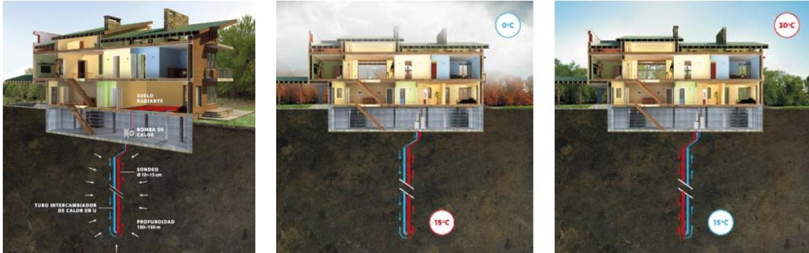
Figura 2. Aprovechamiento geotérmico con intercambiador vertical, BCGT y suelo radiante
