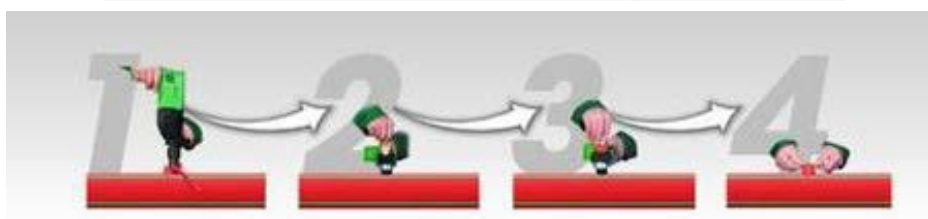
Unión por fusión de tuberías de PP-R faser e inserción de rociadores con derivaciones en asiento soldadas
