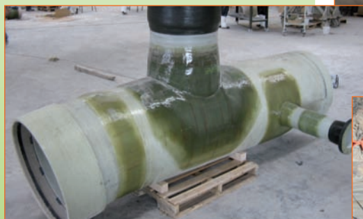
Doble derivación en te con codo DN800-600-150 PN10
