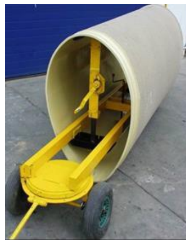
Ilustración 9. Sistema de empujes y desplazamiento de tubos PRFV NC
