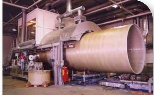
• **Enrollamiento Cruzado** que, a diferencia del sistema anterior, consiste en la conformación de un tubo sobre un mandril mecánico fijo que en un extremo lleva la forma de la campana y sobre el cual se fabrica conjuntamente el tubo y la unión (sistema Campana-Espiga). Se fabrican diámetros desde DN 200 hasta DN 3200 en longitudes útiles desde 1 m hasta 12 m siendo la producción flexible, por tanto, se pueden fabricar varios DN a la vez simplemente cambiando el DN del molde.
