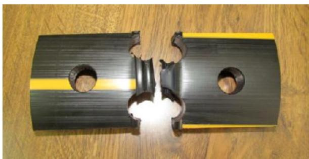
Figura 3. Rotura dúctil probeta Tipo A
