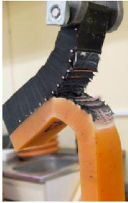
Figura 6. Ensayo 'Peel Test' en curso.
