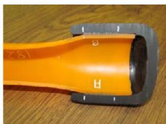
Figura 9. Probeta sector 90°
